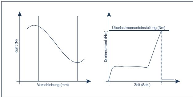
Bei der geringsten Überlast fällt das Drehmoment sofort ab, die Kupplung rastet aus und die Maschine kommt sofort zum Stillstand. Diese Eigenschaft eignet sich besonders bei einer linearen Übertragung frei von kleineren und wiederholten Lastmoment-Variationen und schützt somit Antriebsteile und Produkte.
